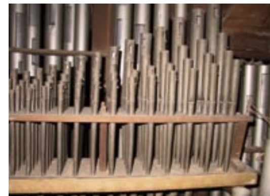
Les tuyaux du Cornet 4 rgs de Silbermann avaient été munis d'entailles de timbre en 1930, pour hausser le diapason d'un demi-ton (photo prise avant restauration).
