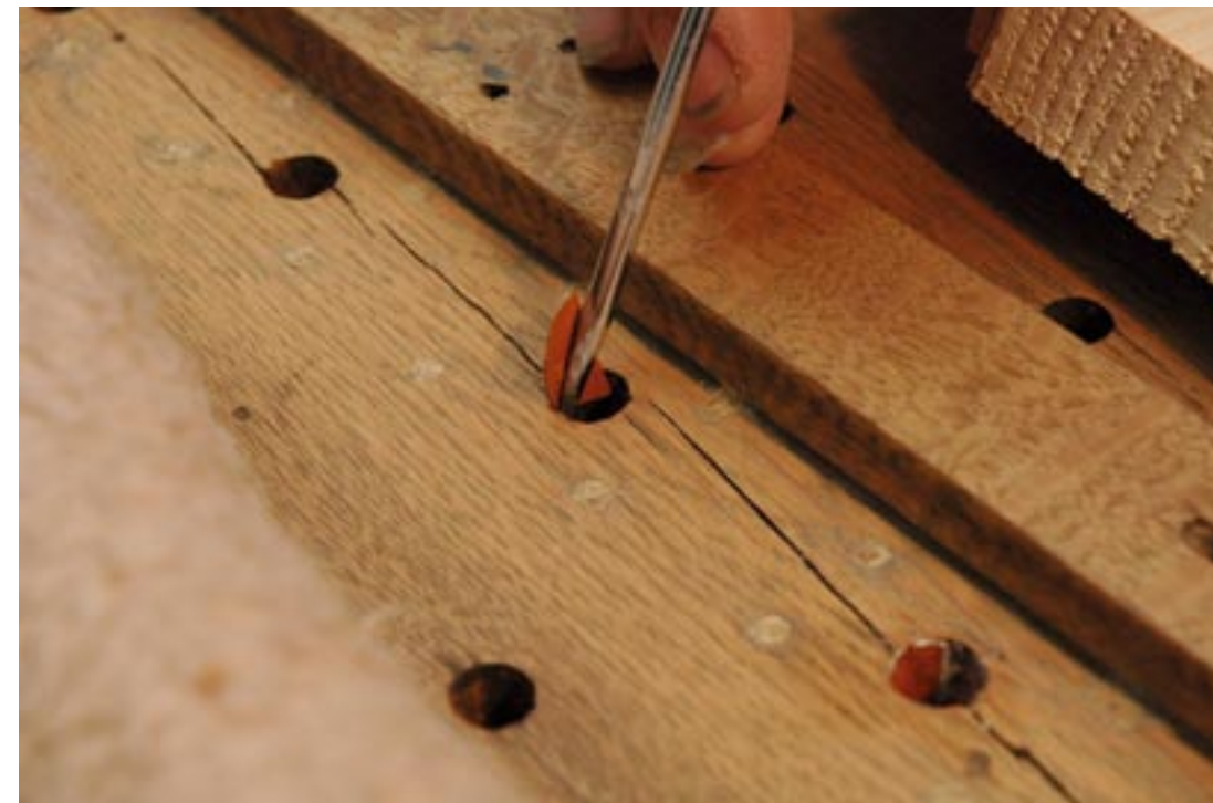
La table du sommier de Silbermann était localement fendue et décollée. Pour y remédier, elle a été tourillonnée et de la peau a été collée dans les perces.
