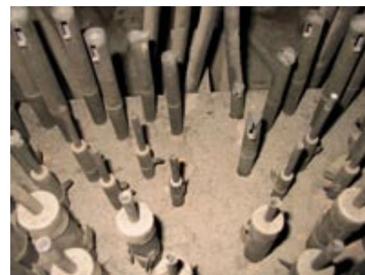
Entre les tuyaux du Prestant 4 et ceux du Bourdon 8, les tuyaux aigus de la Flûte 4 de Silbermann avaient conservé leurs longues cheminées et leurs calottes soudées (photo prise avant restauration).
