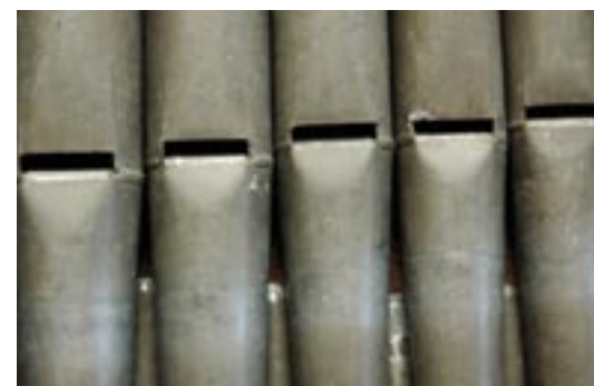
Les tuyaux du Cornet, de Silbermann, sont très bien conservés, avec des bouches intactes et des dents très fines et espacées sur les biseaux.
