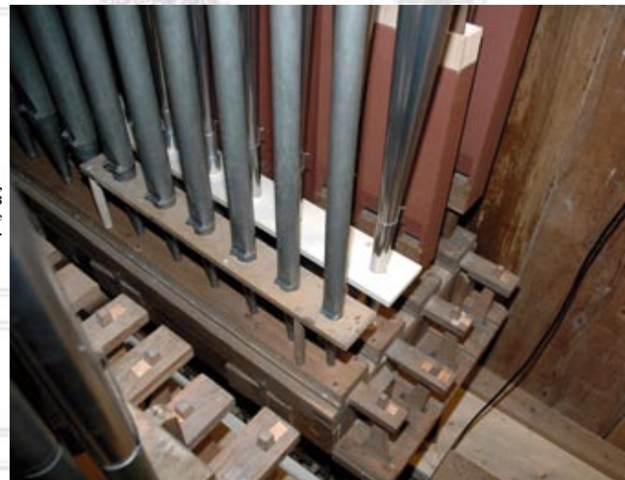
Sur le sommier de pédale de Stiehr, côté #, on remarque le Violoncelle 8 de Stiehr, la Trompette 8 neuve, le Bourdon 8 rallongé et la Flûte 8.
