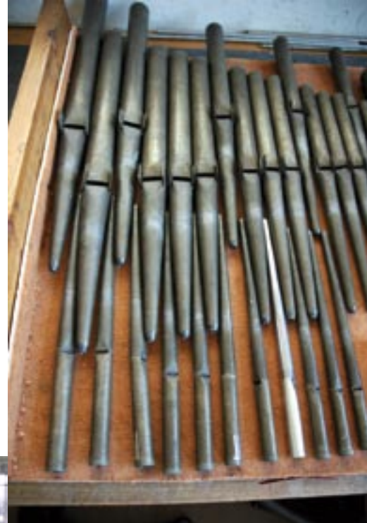
Les dessus du Prestant 4, de Silbermann, en étain sur pieds de plomb, ont été restaurés en ressoudant les entailles de timbre de Kriess, et un tuyau manquant a été refait en copie de ses voisins.
