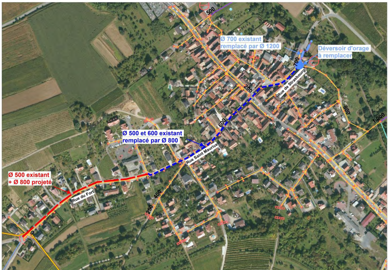
Fig. 23. PROPOSITION DE RENFORCEMENT DU RESEAU D'ASSAINISSEMENT
