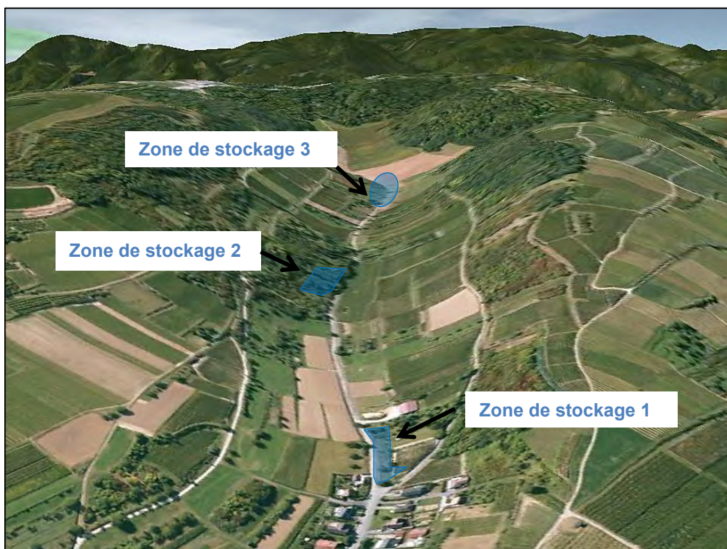
Fig. 19. LOCALISATION DES DIFFERENTS SITES POTENTIELS DE RETENTION D'EAU (IMAGE GOOGLE EARTH)
